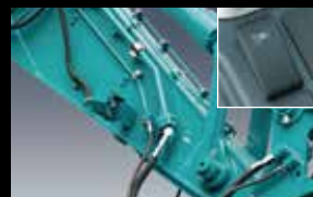
散水装置(オプション) サビ対策としてドレン回路を設けています
