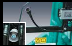
1WAYコール(拡声器システム) クリアな音声品質で周辺作業者に注意を喚起
