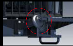
キャブ下ミラー (チルトキャブ仕様) チルト時の足元やキャブ下の安全を確認
