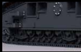
増設トラックガイド(オプション) 解体ガラへの乗り上げによる脱輪を防止
