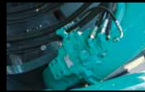
セーフティ配管(ブーム) 配管破断時のアタッチメント落下を防止
