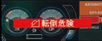
転倒危険警告表示
