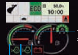
エンジンオイル量と冷却水レベル エンジンオイル量と冷却水レベルチェック画面 緑▶OK 赤▶NG
