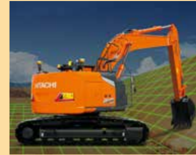
位置情報により掘削面を認識。
