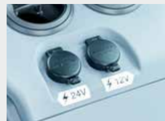
24V電源と 12V電源 NEW
