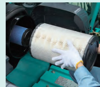
エアクリーナ(ダブルエレメント) 2重フィルタ構造かつ大容量タイプで粉じんの吸気混入を防止。
