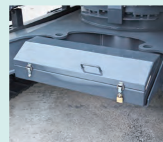
解体用ロウ工具箱* 工具などをに入れておける大容量収納ボックスを装備。
