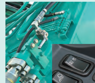
散水装置(ドレン回路付き) ドレン回路を新設。散水後の配管水抜きが可能に。 オプション
