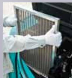
iNDrフィルタの日常点検はダストの溜まり具合の確認のみで、必要であればサッとエアブローするだけの簡単清掃。固定金具を持ち上げるだけのワンタッチ脱着構造なので取り外しも容易です。
