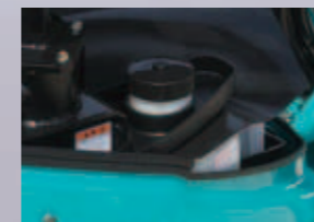
取り外して丸洗いできる樹脂製燃料タンク。
