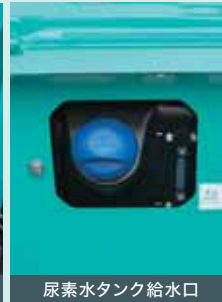
尿素水タンク給水口
